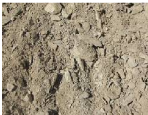
Piçarra, oferece uma primeira resistência, mas depois se desfaz em blocos de diversos tamanhos e até esfarela.
